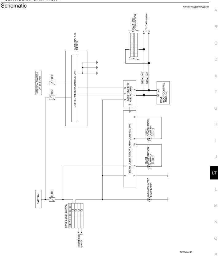
Wiring Diagram - STOP/L -
